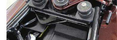
②シートダンパーを変換ステーに、付属のステンレスキャップボルトM6×20を用いて取り付けてください。
