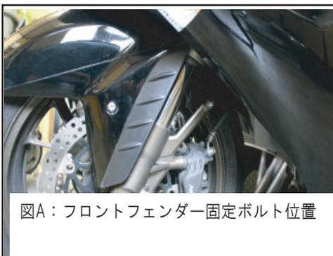
図A：フロントフェンダー固定ボルト位置
