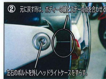
② 元に戻す時は、ボディーの線とステーの点を合わせる。左右のボルトを外しヘッドライトケースをはずす。
