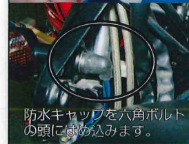
防水キャップを六角ボルトの頭にはめ込みます。
