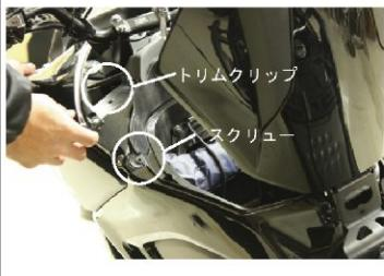
①メインキーを使用し、ラゲッジボックスリッドを開きます。左図を参考に、スクリュー及びトリムクリップを取り外してください。
