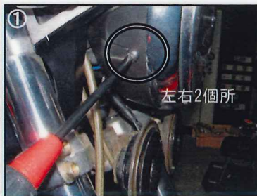
① 左右下側のビスを外しヘッドライトケースを外します。又、ヘッドライトケースやホーンもずらすと作業が行いやすくなります。
