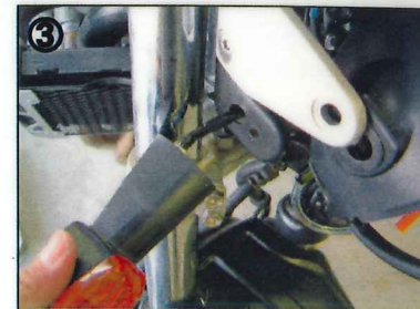
③ ナットを緩め純正ウインカーを外します。
