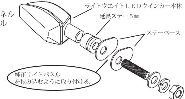
③ライトウェイト LED ウインカーボディの配線を付属の配線用チューブ・防水キャップを取り付け、付属の延長コード 20cm・変換カプラーを使い車体に接続してください。
