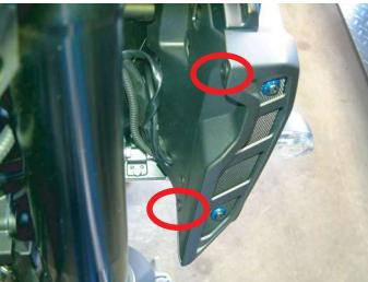
①サイドカバーを止めているボルト・プッシュリベットを取り外しサイドカバーを取り外します。
