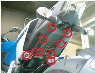
③シートロックのステーベースを取り外してウインカー（左右）の配線を外します。
