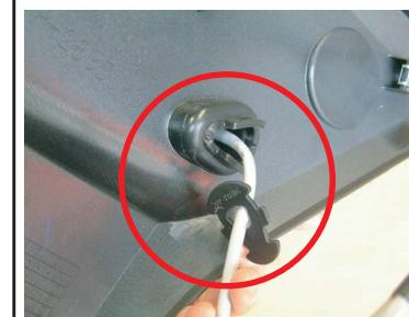
④サイドパネルよりウインカーユニットを取り外します。左図赤丸にて囲まれている部分の樹脂製ウインカーフィット部品をピックやドライバーなどを用いカプラー側へ引き抜きます。
