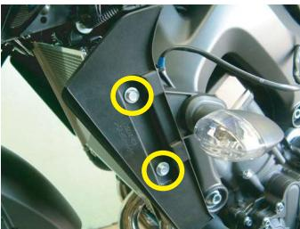
②サイドパネルカバー・サイドパネルを止めているボルトを取り外しサイドパネルカバー・サイドカバーを取り外します。
