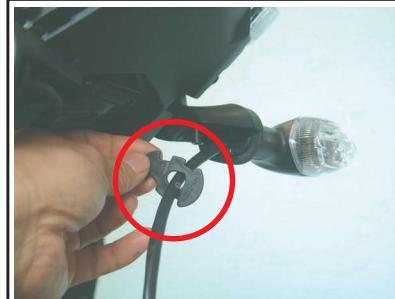
⑤純正ステーよりウインカーユニットを取り外します。左図赤丸にて囲まれている部分の樹脂製ウインカーフィット部品をピックやドライバーなどを用いカプラー側へ引き抜きます。
