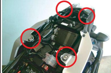
②同様に下部にあるボルト・プッシュリベットを取り外し左右のシートカウルを取り外してください。
