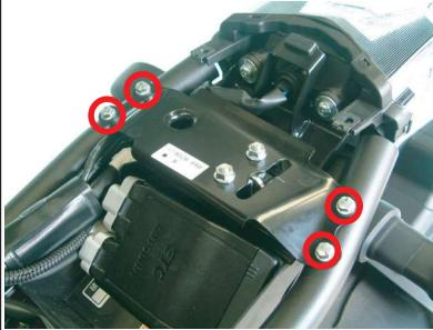
④ボルトを外しウインカーカバーを取り外します。
