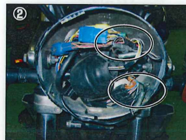
② ノーマルウィンカーの配線をたどり、ヘッドライトボディー内の配線接続部分(ギボシ端子/カプラー)を抜きます。
