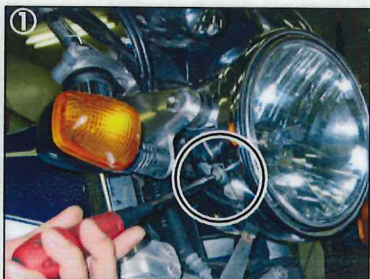
① 左右下側のビスを外しヘッドライトケースを外します。
