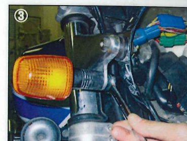
③ ナットを締め純正ウィンカーを外します。
