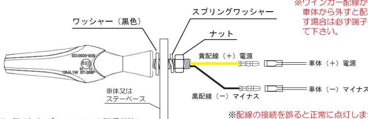
※ウインカー配線が細いので配線を持って端子を車体から外すと配線が切れますので、端子を外す場合は必ず端子をベンチ等で掴んで取り外して下さい。
