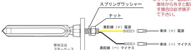
※ウインカー配線が細いので配線を持って端子を車体から外すと配線が切れますので、端子を外す場合は必ず端子をペンチ等で掴んで取り外して下さい。
