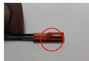
丸印にて囲まれている、極少のプラスチック突起をピックツールなどを用いて手前へわずかに持ち上げてください。
